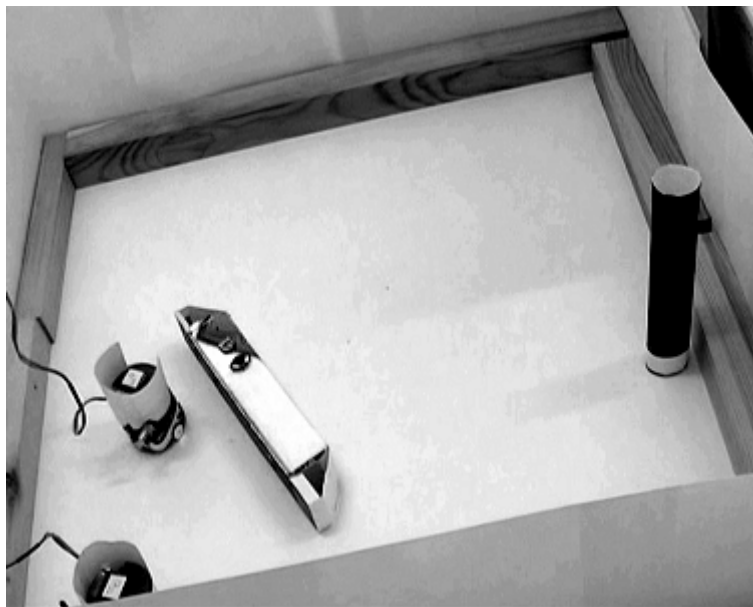
Obrázek 24 - Navigace robotu směrem k IR diodě v boxu
